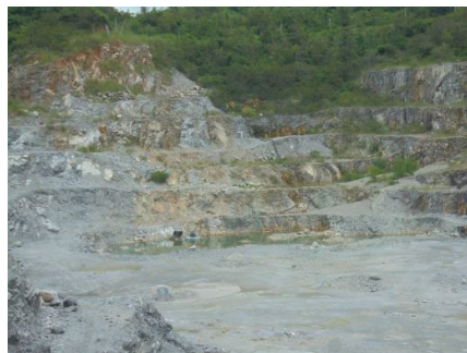
รูปที่ 2-10: การทำเหมืองแบบขั้นบันได
