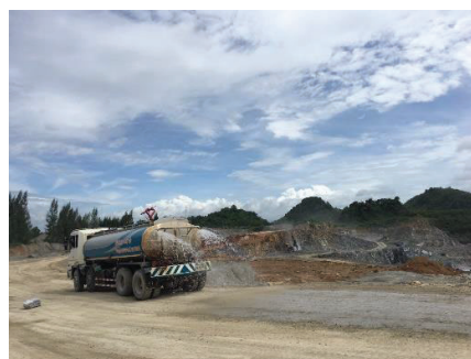
รูปที่ 2-14: การฉีดพรมน้ำหน้าเหมือง
