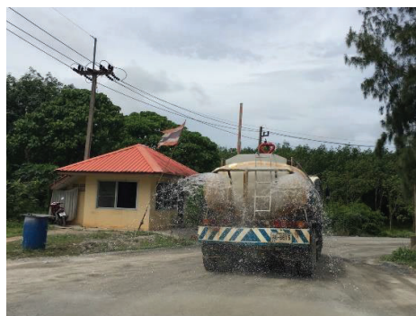
รูปที่ 2-12: การฉีดพรมน้ำบนเส้นทางขนส่งแร่
